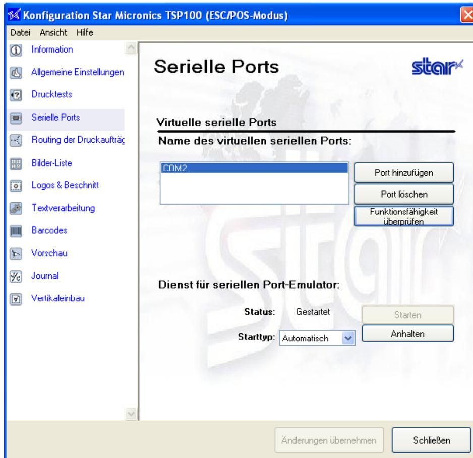
Prüfen Sie Ihre Eingaben, indem Sie den eingegebenen ComPort in der Listenansicht auswählen und anschließend auf [Funktionsfähigkeit überprüfen] klicken. Wenn alles korrekt ist, sollte der Drucker einen entsprechenden Testausdruck generieren.
